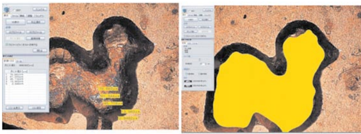
Рис. 15. Отображение высот и расчет объема
