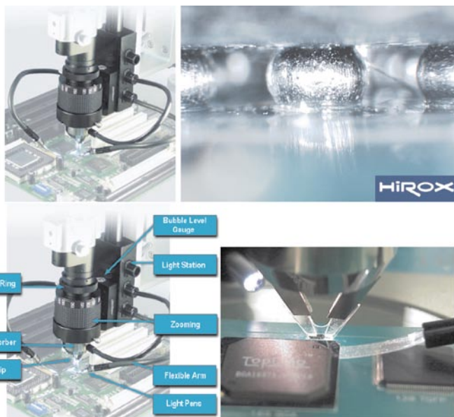
Рис. 10. Принцип 3D инспекции
